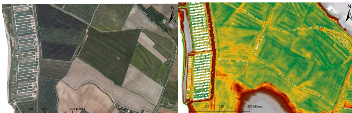
Figure 19 – Photographie aérienne (à gauche) et modèle numérique de terrain (à droite, réalisé par J.-F. Breilh, étudiant à l'Université de La Rochelle) réalisé à partir des mesures par laser aéroporté (données fournies par l'EPTB Charente). La maille des données est de 5 m avec une précision théorique verticale de 5 à 25 cm.
