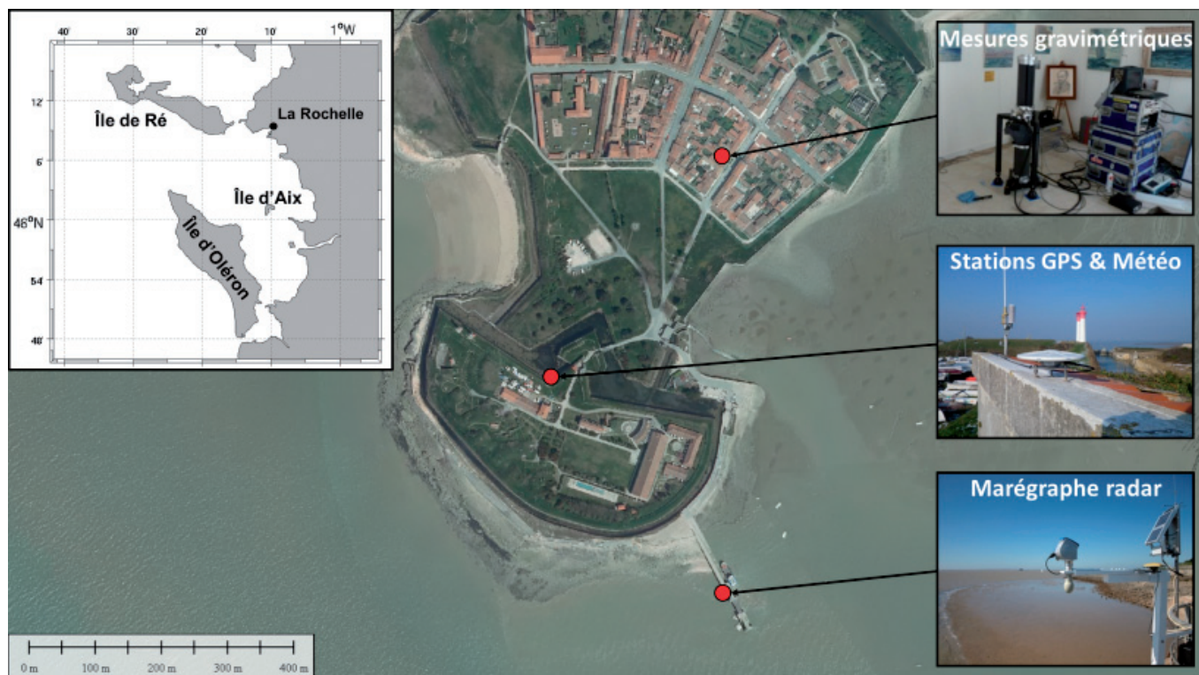
Figure 1. Observatoire du niveau de la mer de l'île d'Aix. Cet observatoire comprend un marégraphe radar, une station météorologique et une station GPS.
