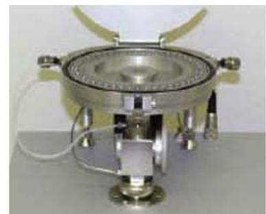
L'analyseur élémentaire est équipé de l'option SmartEA qui, en conjugaison avec l'interface ConFlo IV, permet la dilution automatique des gaz échantillons pour les ajuster au niveau des gaz de référence, pour chaque élément. Une gamme de poids assez large peut être analysée grâce à la dilution automatique, mais un minimum de 10 µg de C et de N est nécessaire pour avoir une bonne précision.
