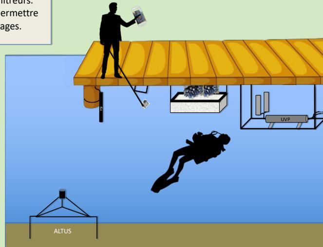
Les **paramètres environnementaux** : température, salinité, turbidité et quantité de chlorophylle sont obtenus à l'aide de **capteurs multiparamétriques** (YSI). Un **altimètre (ALTUS)** permet de quantifier précisément les **variations de la couche de vase**.
